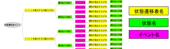
状態遷移表テストの設計にマインドマッピングツールを利用する
